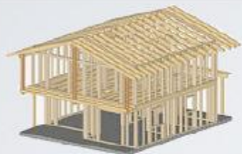
STRUTTURA A TELAIO
